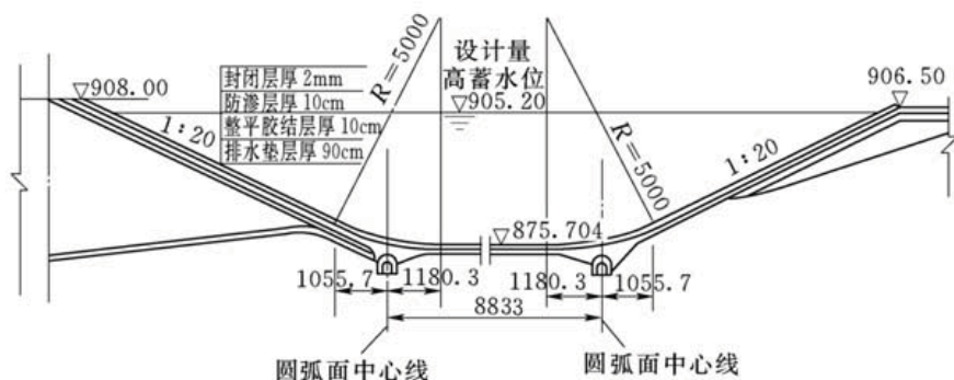
图 6-1 沥青混凝土面板结构
